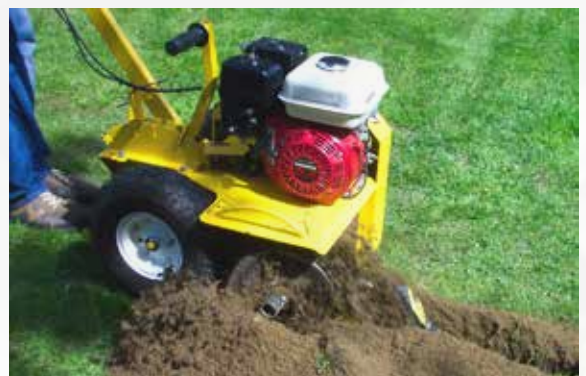
Seitlicher Erdbodenauswurf durch Förderschnecke.
